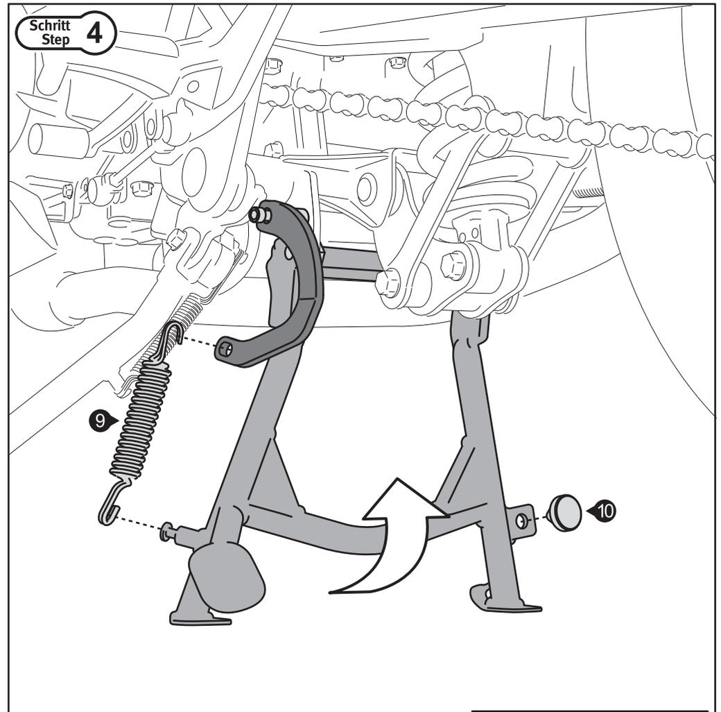
Klappen Sie den Hauptständer vollständig nach oben. Benutzen Sie einen geeigneten Heber, um ihn in Position zu halten. Setzen Sie nun mit einem geeigneten Werkzeug den Zugfedersatz (9) ein (siehe Detailzeichnung, Zugfeder-Montagewerkzeug (WFF.00.138.100) separat erhältlich). Setzen Sie abschließend den Gummidämpfer (10) wie gezeigt ein.
