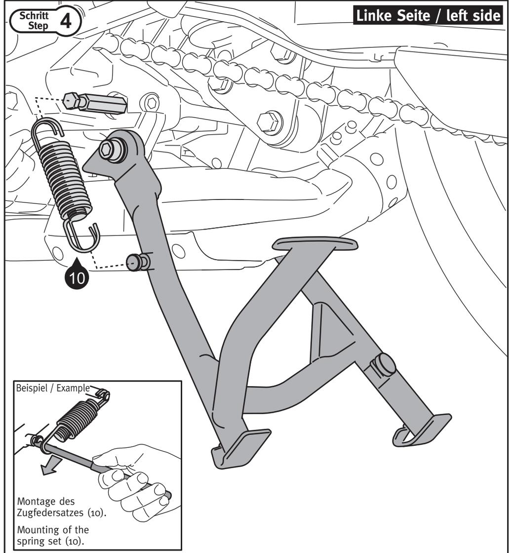
Klappen Sie den Hauptständer vollständig nach oben. Benutzen Sie einen geeigneten Heber, um ihn in Position zu halten. Setzen Sie nun mit einem geeigneten Werkzeug den Zugfedersatz (10) ein (siehe Detailbild).
