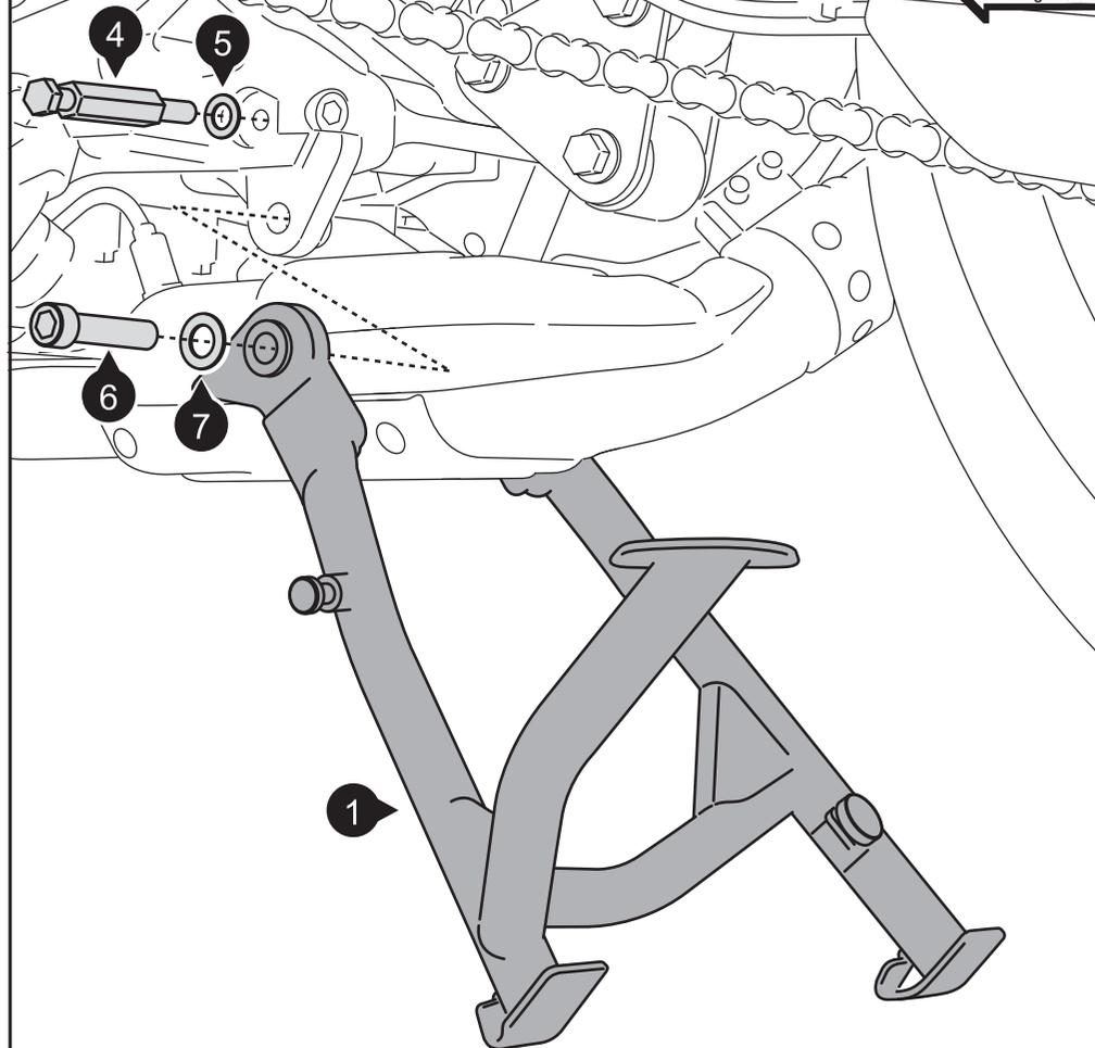
Verschrauben Sie den Federbolzen (4) am Fahrzeug. Sichern Sie den Federbolzen (4) mit flüssiger Schraubensicherung. Ziehen Sie anschließend den Federbolzen (4) an.
