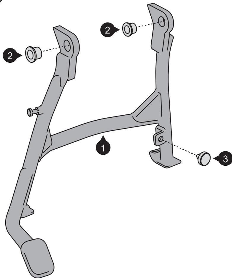
Setzen Sie die Laufbuchsen (2) mit Schmierfett in die Öffnungen des Hauptständers (1) ein.
