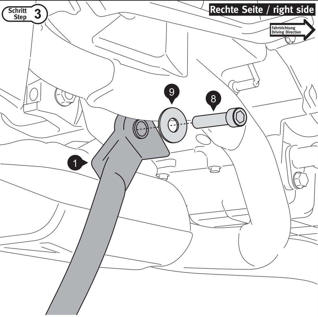
Verschrauben Sie nun den Hauptständer (1) auf der rechten Fahrzeugseite. Sichern Sie Schraube (8) mit flüssiger Schraubensicherung. Ziehen Sie anschließend Schraube (8) an.
