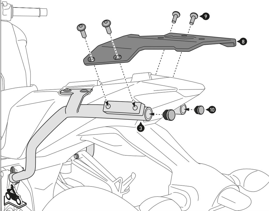
*HINWEIS: Falls die Montage einer QUICK-LOCK Adapterplatte vorgesehen ist, sollten die Haltenocken am ALU-RACK vor dessen Anbau am Fahrzeug verschraubt werden.*
