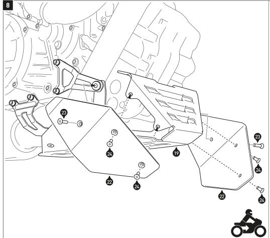
Verschrauben Sie die Verkeidungsteile (22) mit dem Unterteil (19) wie in der Zeichnung gezeigt. ACHTUNG: Verwenden Sie flüssige
