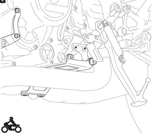
Verschrauben Sie den Seitenständer am Fahrzeug, wie in der Zeichnung gezeigt. Ziehen Sie die originalen Schrauben nach Herstellerangaben an.
