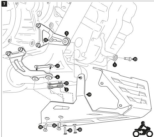
HINWEIS: Fixieren Sie das Unterteil (19) mit den Schrauben (23) an den Anbaublechen (1) und (3), um die Montage zu erleichten.
