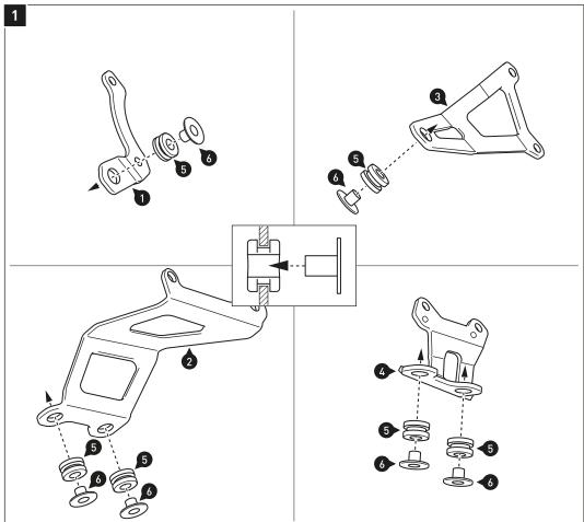
Setzen Sie die Gummitüllen (5) in die Öffnungen der Anbaubleche (1), (2), (3) und (4) ein, wie in der Zeichnung gezeigt. Drücken Sie anschließend die Bundbuchsen (6) in die Öffnungen der Gummitüllen (5).
