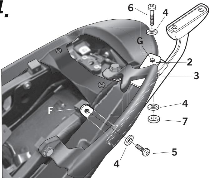
**E** Montar el soporte KIT TOP (3), en zona (F), mediante las arandelas (4) y el tornillo (5), y en zona (G) unirlo al pasamano (2) mediante los tornillos (6), las arandelas (4) y las tuercas (7).
