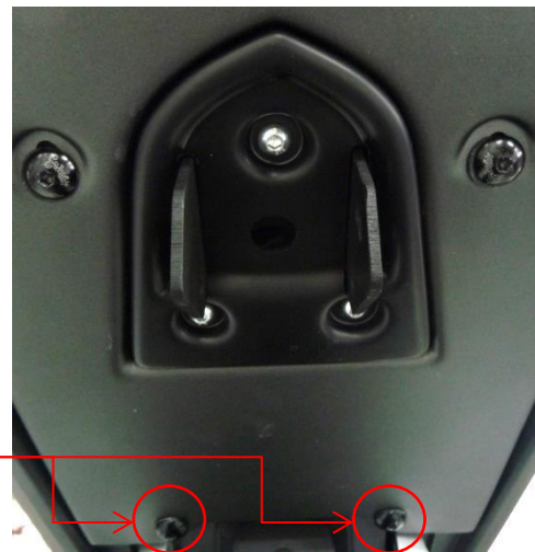
Position des vis 5×25 et des entretoises
