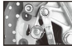
Réglez la position de support de capteur de sorte que le capteur est en face de l'aimant pour éviter un mauvais signal de vitesse ou une absence de signal.
