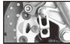
Installez le support du capteur de type S.
