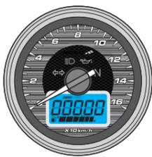
Sur l'écran d'accueil, appuyez sur **Sélection et Réglage** pendant 3 secondes pour accéder à l'écran Réglage de la circonférence de pneu et du point de détection.
