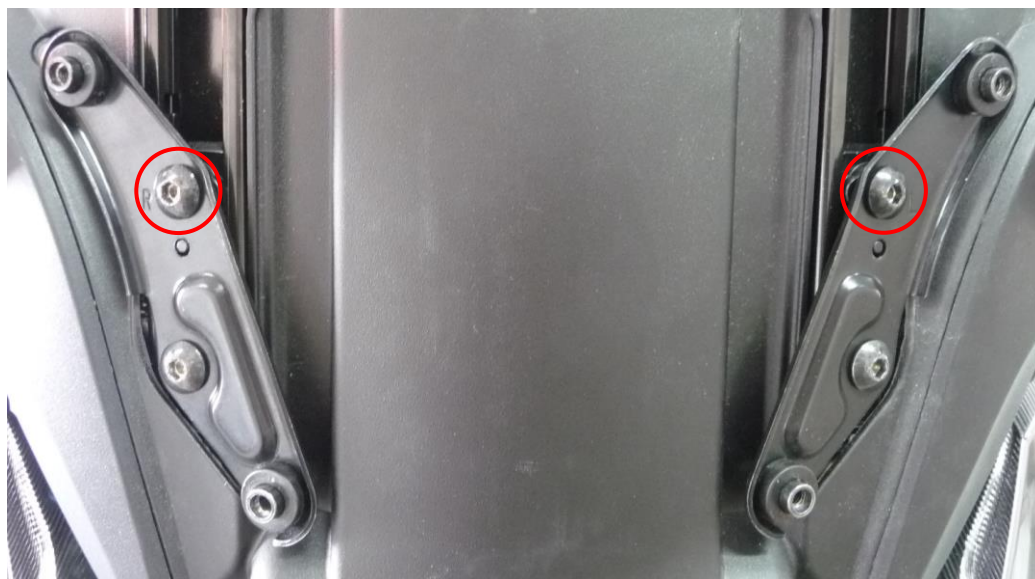
Vis à démonter pour insérer la rondelle (celle-ci se place sous la patte de fixation)
